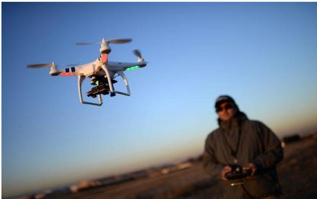
无人驾驶飞机简称“无人机”，英文为“Unmanned Aerial Vehicle, UAV”，是利用无线电遥控设备和自备的程序控制装置操纵的不载人飞机。机上无驾驶舱，但安装有自动驾驶仪、程序控制装置等设备。地面、舰艇上或母机遥控站人员通过雷达等设备，对其进行
